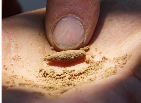
Cuanto más tiempo se pueda rodar el cilindro antes de que se rompa, mayor será el contenido de arcilla en el suelo. El ejemplo de la foto es de un suelo arenoso con poco contenido de arcilla.
