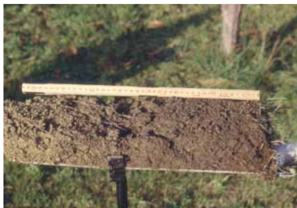
Rýčová zkouška: malá pracnost, velký užitek. Tato metoda umožňuje posouzení půdní struktury i laikům.
