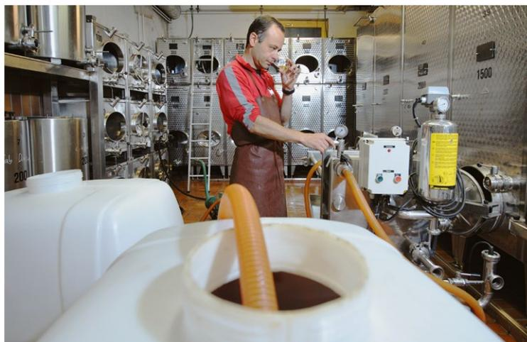
Filtrazione del vino mediante un filtro a piastre
