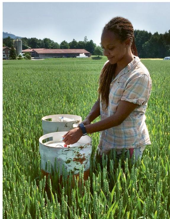
Bestimmung der Treibhausgasemissionen im Ackerbau. Mithilfe von manuellen Kammern, die regelmässig auf einen im Boden versenkten Ring montiert werden, können die vom Boden emittierten Treibhausgase gesammelt, nach einer kurzen Zeit mit einer Spritze entnommen (Bild) und anschliessend im Labor an einem Gaschromatographen gemessen werden.
