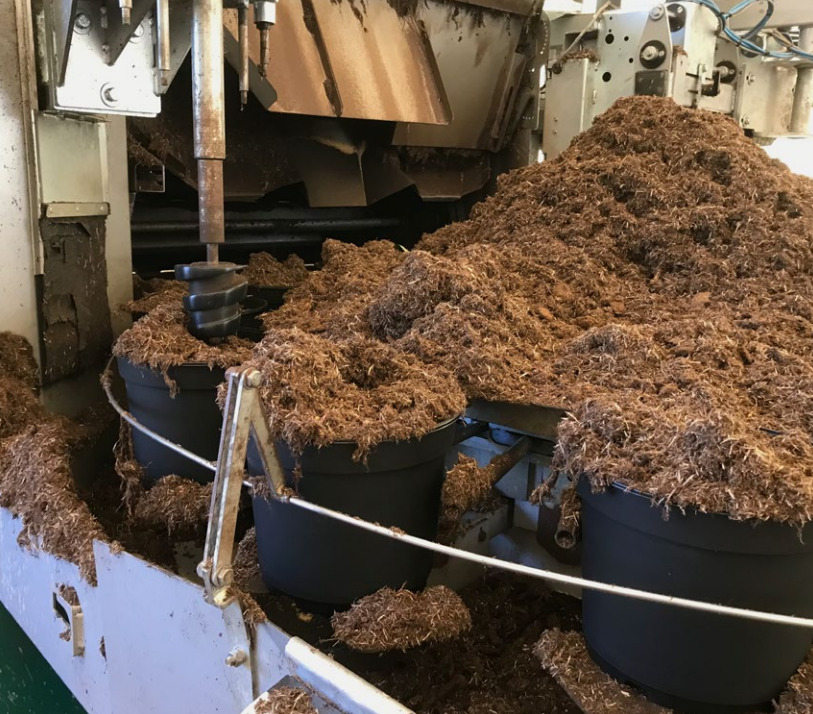
Töpfe werden maschinell mit torfreduziertem Baumschulsubstrat befüllt.
