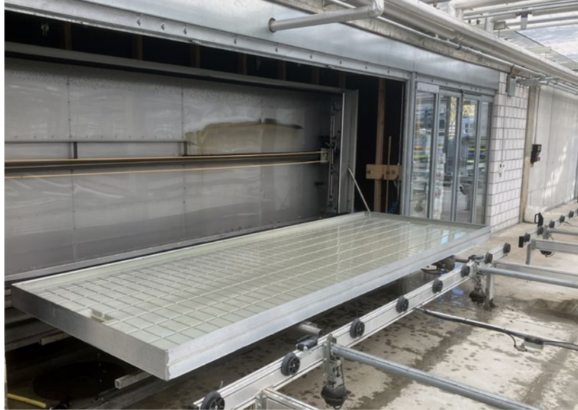
Un système de lavage des tables permet de nettoyer efficacement les tables de culture dans la serre.
