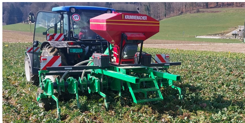
Dans les cultures sarclées, la charrue à billons permet d'effectuer le travail du sol, les semis et le désherbage à l'aide d'un seul outil.
