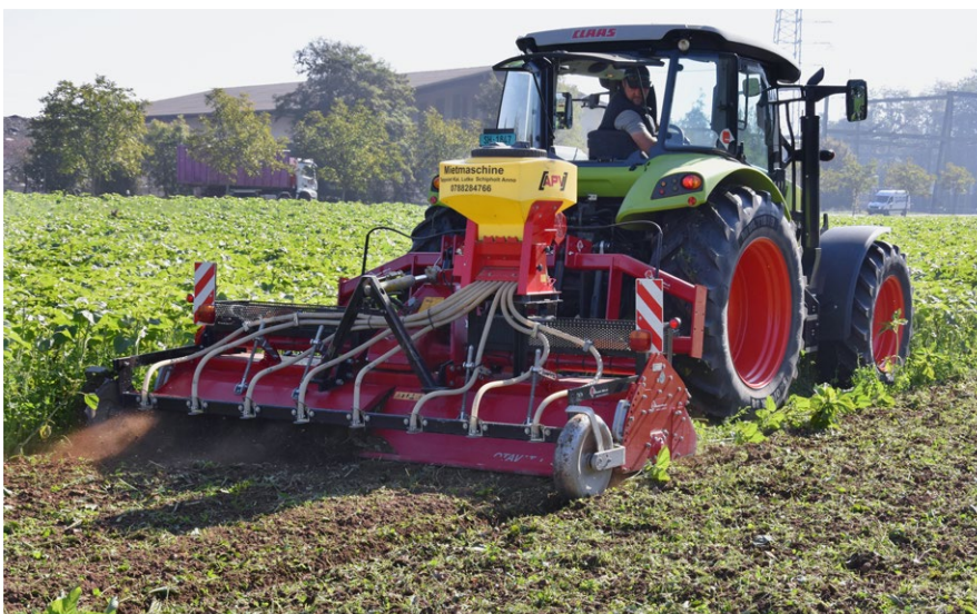
Dans le cas de faible biomasse des couverts végétaux, leur incorporation et le semis de la culture suivante peuvent être effectués en une seule opération.
