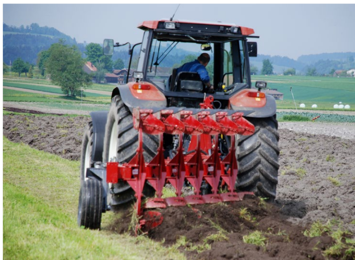
Au lieu d'utiliser une charrue traditionnelle, le labour d'une prairie temporaire peut être effectué à l'aide d'une charrue déchaumeuse.
