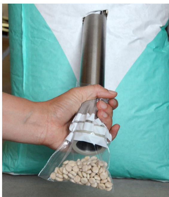
La lancia per il campionamento può essere utilizzata anche per prelevare singoli campioni dagli strati inferiori di un sacco.
