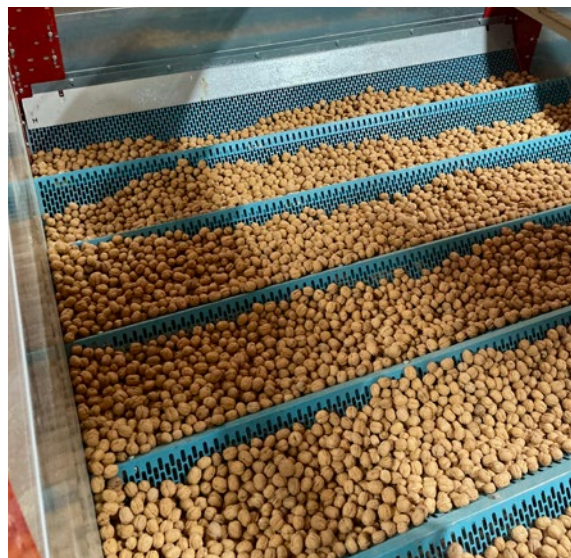
Dans une installation de séchage, les noix sont séchées mécaniquement. La photo ci-dessus montre le séchoir industriel de la société Nuss Thurgau AG à Hörhausen.
