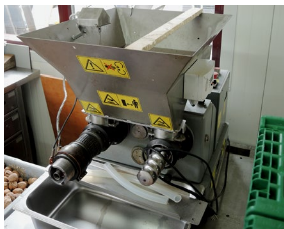
La fabrication de l'huile de noix se fait à l'aide d'une presse à huile, ici la presse de la société Nussöli à Wilen Gotthaus SG.
