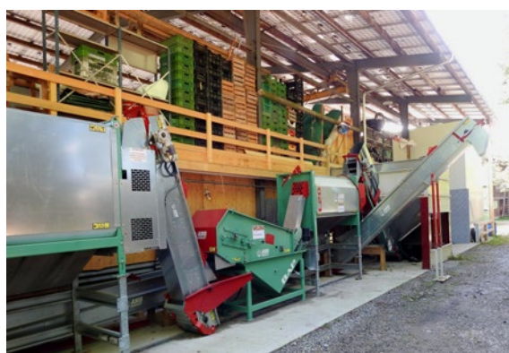
L'installation de la société Nuss Thurgau AG à Hörhausen est composée d'une machine de lavage (à droite), d'un séparateur de pierres (au milieu) et d'une laveuse-écaleuse (à gauche).
