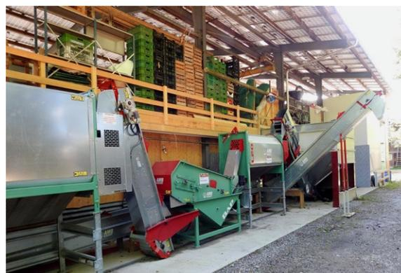
Die Anlage der Nuss Thurgau AG in Hörhausen besteht aus Waschmaschine (rechts), Steinseparator (Mitte), und Wasch- und Enthüllungsmaschine (rechts).
