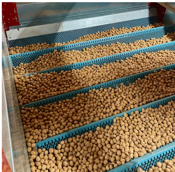
In einer Nusstrocknungsanlage werden die Nüsse maschinell getrocknet. Oben ist die Anlage der Nuss Thurgau AG in Hörhausen abgebildet.
