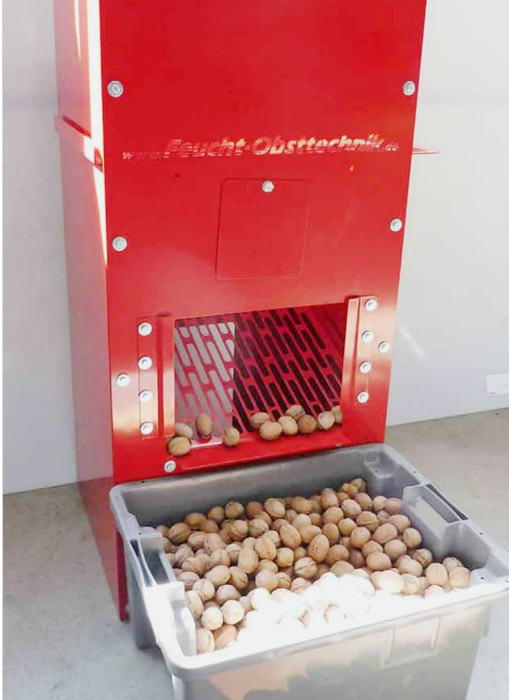
Die Firma Feucht Obsttechnik bietet Geräte für Kleinbetriebe für die Trocknung der Nüsse an, hier der Trockner Mini.
