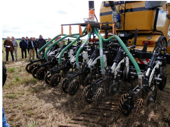
Figur 16: Gyllenedfældningsteknologi reducerer ammoniakemissioner, derved forbedres næringsstofcyklus og luftforurening reduceres.
