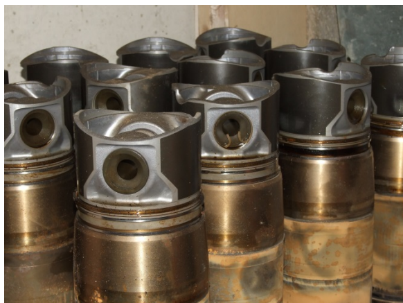
Figur 28: Det er afgørende for pålidelig drift med et regelmæssigt eftersyn af CHP-motoren. På billedet: Motorens cylinderstempler. Foto: F. Gerlach, MEP.
