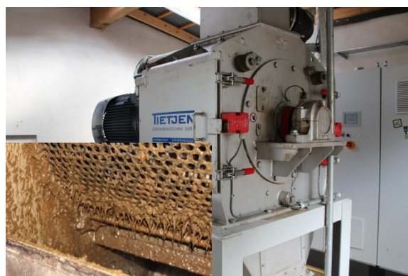
Rys. 22: W przypadku średnich i dużych biogazowni, techniki dezintegracji, jak ta kombinacja młyna młotkowego i określonych mikroorganizmów, mogą poprawić efektywność i niezawodność. Zdjęcie: F. Gerlach, FiBL.
