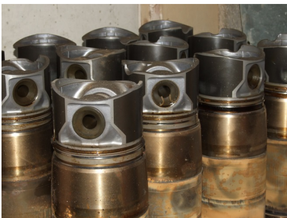
Rys. 28: Zasadnicze znaczenie dla niezawodnego działania mają regularne remonty jednostki CHP. Na zdjęciu: tłoki cylindrowe silnika. Zdjęcie: F. Gerlach, MEP.
