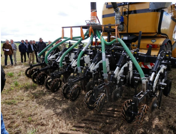
Rys. 16: Technologia wtrysku gnojowicy zmniejsza emisję amoniaku, poprawiając w ten sposób recykling składników odżywczych i zmniejszając zanieczyszczenie powietrza. Zdjęcie: N. Hölzer, MEP.
