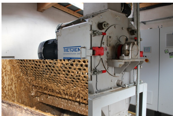
Figure n°22 : Pour les installations de biogaz de moyenne et grande taille, les techniques de désintégration telles que la combinaison d'un broyeur à marteaux et de micro-organismes spécifiques peuvent améliorer l'efficacité et la fiabilité. Photo : F. Gerlach, FiBL.
