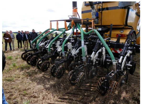
Figure n°16 : La technologie d'injection de lisier réduit les émissions d'ammoniac, améliorant ainsi le recyclage des éléments nutritifs et réduisant la pollution de l'air. Photo : N. Hölzer, MEP.
