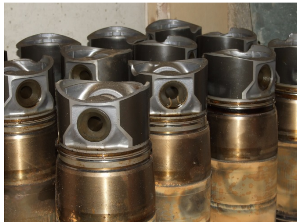
Figure n°28 : Une révision régulière de l'unité de cogénération est vitale pour assurer un fonctionnement fiable. Sur la photo : pistons de cylindres de moteurs. Photo : F. Gerlach, MEP.
