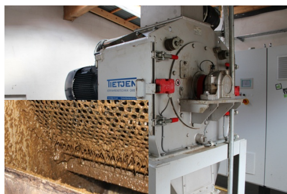
Figura 21: Para las plantas de biogás medianas y grandes, las técnicas de desintegración como esta combinación de molino de martillo y microorganismos específicos, pueden mejorar la eficiencia y fiabilidad. Foto: F. Gerlach, FiBL.
