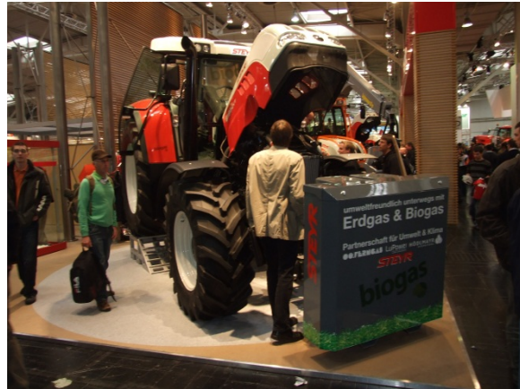
Figura 29: Los primeros tractores alimentados por biogás atraen la atención en las ferias y en los campos. El biogás mejorado se almacena en tanques bajo piso y, opcionalmente, en la parte delantera. Foto F. Gerlach, MEP.
