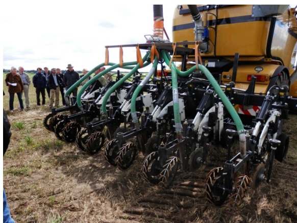
Figura 16: La tecnología de inyección de digestato líquido reduce las emisiones de amoníaco, lo que mejora el reciclaje de nutrientes y la reducción de la contaminación del aire. Foto: N. Hölzer, MEP.
