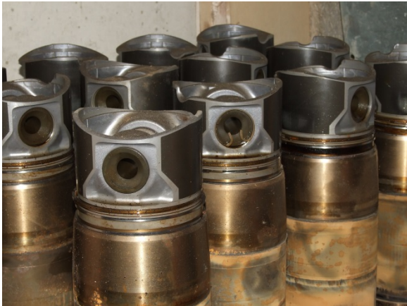
Figura 27: Vital para un funcionamiento fiable es la revisión periódica de la unidad de cogeneración. En la foto: pistones de los cilindros del motor. Foto: F. Gerlach, MEP.
