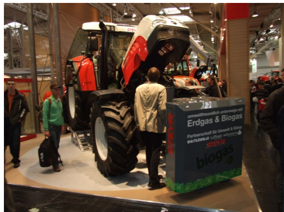
Abbildung 30: Der erste mit Biomethan betriebene Traktor erweckt auf Messen und Feldern Aufmerksamkeit. Aufbereitetes Biogas kann in Tanks unter dem Boden und im Fronanbau gespeichert werden. Foto: F. Gerlach, MEP.
