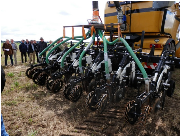
Abbildung 16: Moderne Gülleeinbringungsverfahren reduzieren Ammoniakemissionen und verbessern den Nährstoffkreislauf. Foto: N. Hölzer, MEP.
