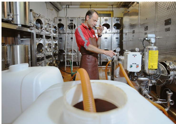
Filtration du vin au moyen d'un filtre à plaques
