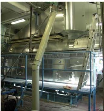
Abbildung 25: Heißluftanlage „Thermoseed“
