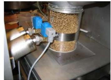
Abbildung 27: Anlage zur Ultraschall-Dampf-Behandlung „Sonosteam“
