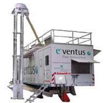
Abbildung 29: Mobile Anlage zur Elektronenbehandlung
