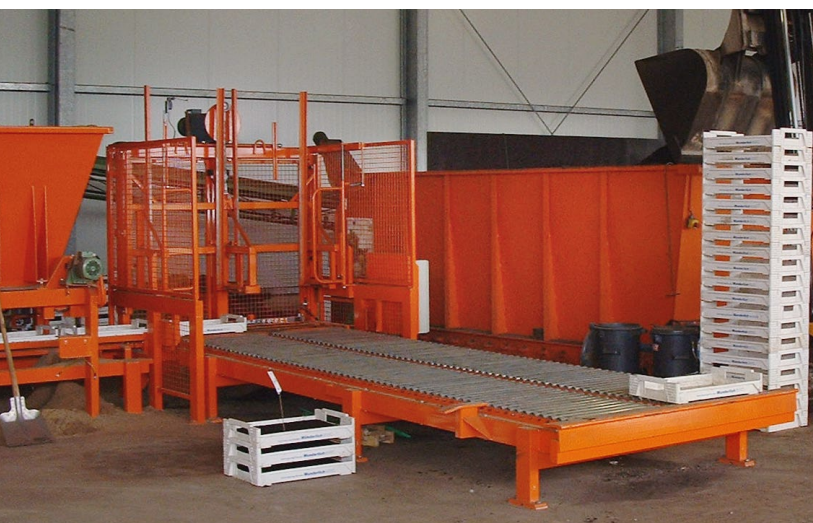
Postrojenje za mešanje supstrata i punjenje posuda
