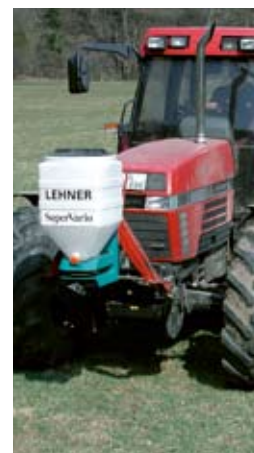
Combinés à une herse étrille et à un rouleau, les épandeurs de granulés anti-limaces conviennent très bien pour les sursemis.
