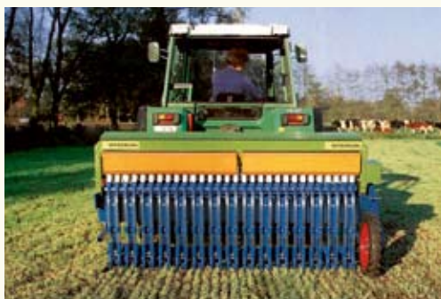
Les semoirs pour semis direct en lignes conviennent dans les sols plats. Dans les sols humides, ils bourrent moins que les semoirs pour semis sur bandes fraisées.
