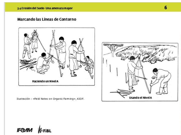
TRANSPARENCIA 3.4.3(6): CONSTRUYENDO Y USANDO UN NIVEL A PARA IDENTIFICAR LAS CURVAS DE NIVEL. FUENTE: "FIELD NOTES ON ORGANIC FARMING", KIOF).
