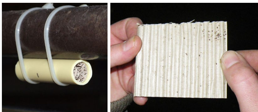
Refugiile artificiale pentru acarieni permit detectarea timpurie a paraziților în adăpost și combaterea rapidă (stânga: capcană pentru acarieni montată, dreapta: capcană pentru acarieni deschisă, care conține acarieni).
