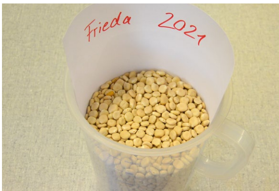
Die Proben von verschiedenen Stellen einer Charge werden zu einer Sammelprobe vermischt (gut homogenisiert).
