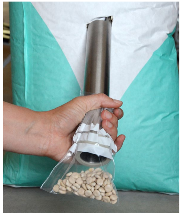
Mit dem Probenspeer lassen sich Einzelproben auch aus den unteren Schichten von einem Sack entnehmen.
