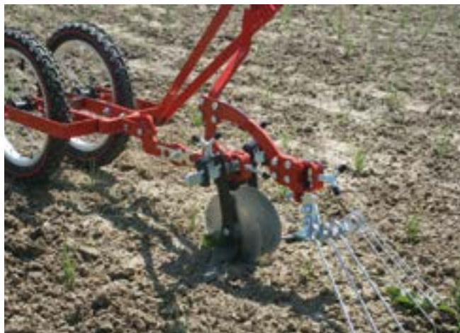
Radhacken sind eigentlich Geräteträger. Hier ist eine Zweiradhacke mit Schermesser und Striegel zu sehen. (© Wolfgang Palme)
