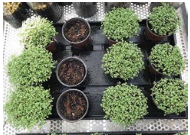
Abbildung 2: Mit einem Kressetest kann die Kompostreife und eine etwaige Phytotoxizität des Kompostes überprüft werden. (© Michaela Schlathölder, lizenziert unter CC-BY-NC-SA 4.0)
