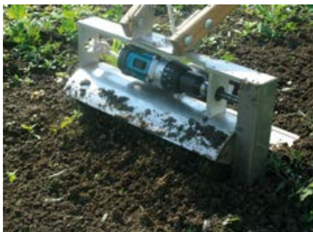
Tilther oder Minifräse nennt sich jenes Gerät aus den USA (Johnny's Selected Seeds), mit dem man nur die obersten 3–5 cm des Bodens bearbeitet. Angetrieben wird es durch einen Akkuschauber. (© Wolfgang Palme)
