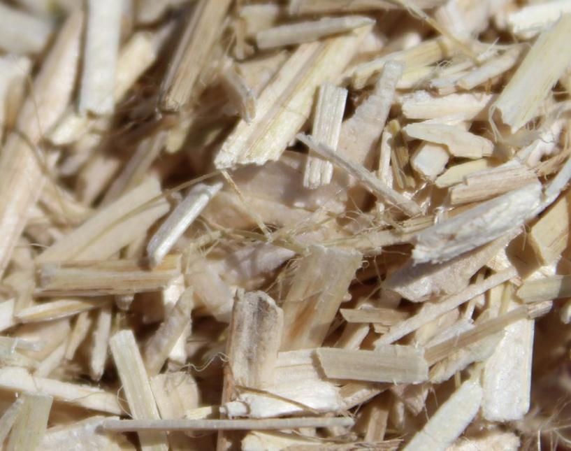
Schäben fallen bei der Faserproduktion als Reststoff an.
