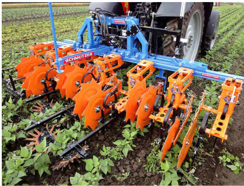
Zatímco v polní produkci se používají především plecí brány, v produkci zeleniny se uplatňuje sofistikované plečkovací nářadí.
