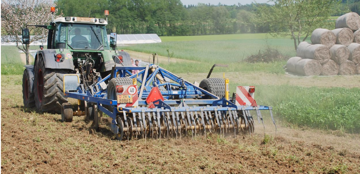
Scalparea superficială a pajiștii cu un cultivator echipat cu cujite «labă de găscă» (de exemplu, cultivatorul de precizie Treffler) lasă smocuri de iarbă foarte mici, care se usucă rapid.
