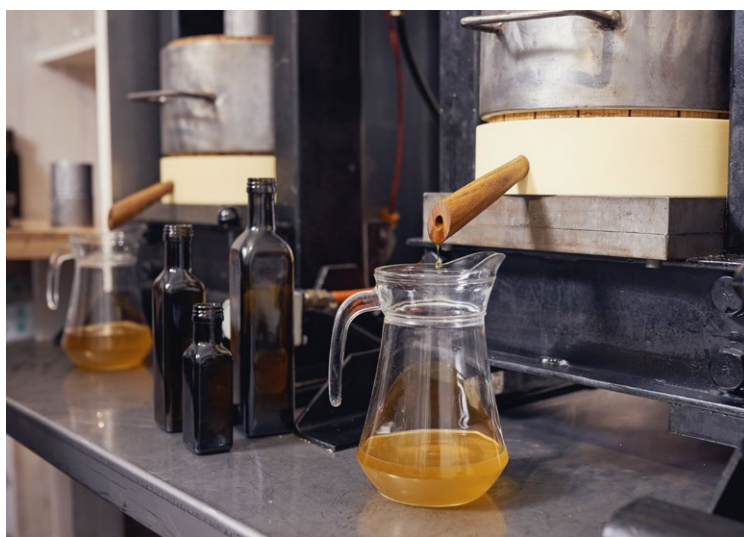
Прессование льняного масла в небольшом производстве.
