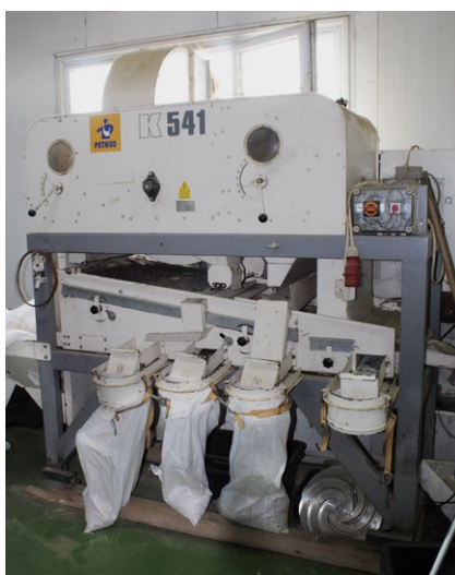
Ndarësi (separatori) për të hequr grimcat e imëta dhe për të klasifikuar produktin e tharë në kategori të ndryshme.
