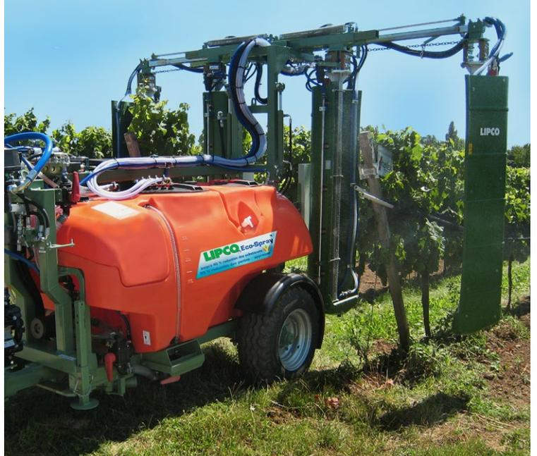
Les pulvérisateurs sous tunnel sont équipés de panneaux récupérateurs sur les côtés et en haut, de sorte que la culture se trouve dans un «tunnel».
