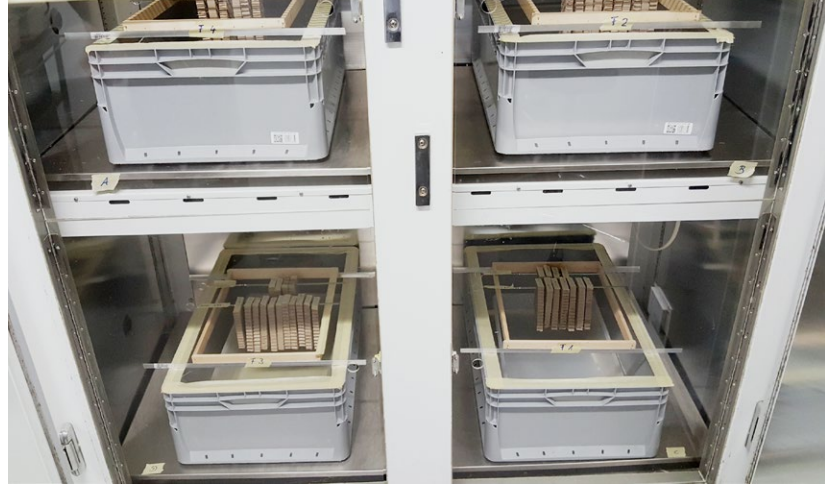
In einem Klimaschrank lassen sich die optimalen Brutbedingungen einstellen. Über den Futterboxen sind je 40 000 Eier in Wabenkartons platziert.
