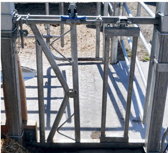
Das Fressfanggitter ist mit einem selber konstruierten Bügel mit Schnellverschluss versehen.
