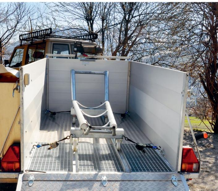
Der für den Transport des toten Rindes zugelassene T-Trailer mit dem Schragen, auf den das entblutete Tier gelegt wird. Solche Anhänger ermöglichen den hygienischen Transport des Schlachtkörpers in ein nahegelegenes Schlachtlokal.
