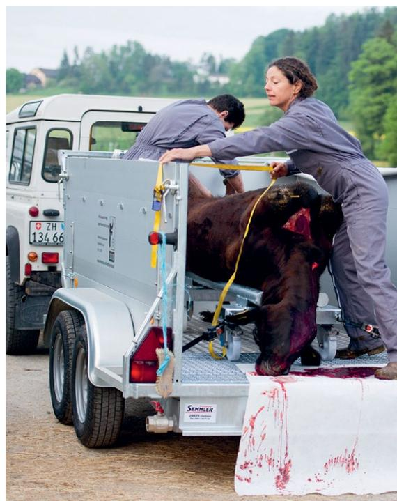
Der für Weidetötungen in Deutschland angefertigte T-Trailer besteht grösstenteils aus Aluminium und entspricht den Vorgaben der EU-Hygieneverordnung. Er kann sowohl an einen PKW als auch an einen Traktor angehängt werden. Der Anhänger eignet sich auch für den Transport von Tieren aus Hof-tötung.
