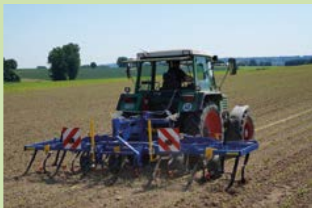
Forrás: www.treffler.net -Treffler speciális sorközművelő kultivátor
