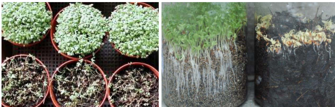
Links: Offener Kresstest. Die schlecht entwickelte Kresse in den Töpfen der unteren Reihe deutet auf einen Kompost mit phytotoxischer Wirkung hin. Rechts: Geschlossener Kresstest. Der Kompost im rechten Gefäss wirkt phytotoxisch.
