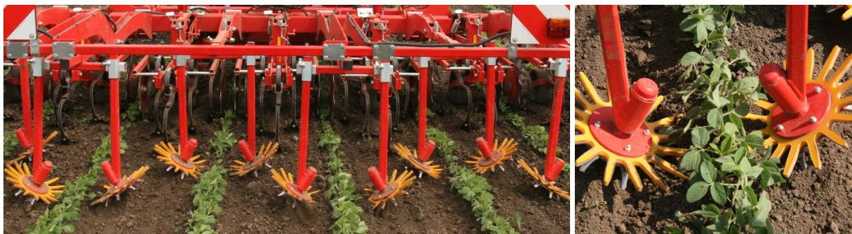
Foto 1: Kombination von Fingerhacke und Gänsefußscharen in Soja. Foto 2: Arbeit der Fingerhacke in der Reihe. (Fotos: Goran Malidza, Institute of Field and Vegetable Crops, Novi Sad).
