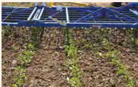
Češljasta drljača firme Treffler iz Nemačke
