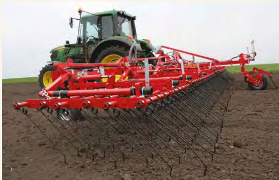
Primena češljaste drljače na slepo
