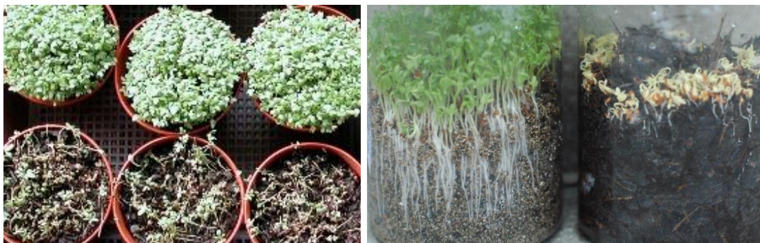
Links: Offener Kresstest. Die schlecht entwickelte Kresse in den Töpfen der unteren Reihe deutet auf einen Kompost mit phytotoxischer Wirkung hin. Rechts: Geschlossener Kresstest. Der Kompost im rechten Gefäss wirkt phytotoxisch. (Fotos: Jacques Fuchs, Forschungsinstitut für biologischen Landbau FiBL, Frick)
