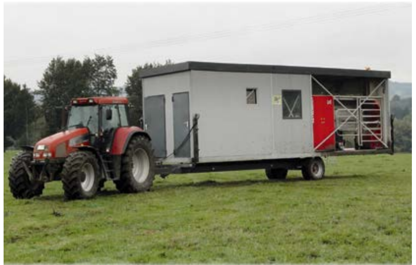
Mobile Melkroboter, die im Sommer auf der Weide stehen und im Winter im Stall, ermöglichen es, Vollweide mit Melkroboter zu kombinieren, auch wenn die Weiden nicht in Stallnähe liegen. Einzelne Landwirte haben den Melkroboter in einem Container untergebracht oder an eine Baggerraupe angebaut.
