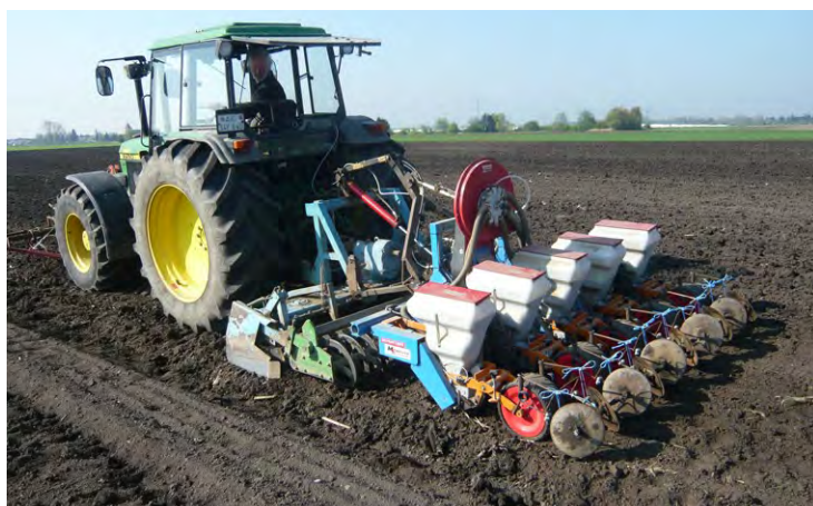
Manche Landwirte bringen bei der Saat kleine Dammformer an, die zirka 5 cm hohe Dämme auf die Saatreihen aufschütten. In diesem Fall werden die Sojabohnen nur 2–3 cm tief gesät. 3–4 Tage nach der Aussaat erfolgt dann ein sehr scharfer Durchgang mit dem Striegel, um die Erde wieder abzutragen. Diese Methode setzt eine optimale Bodenfeuchtigkeit voraus, um ein gutes Auflaufen der Sojakeimlinge zu gewährleisten.
