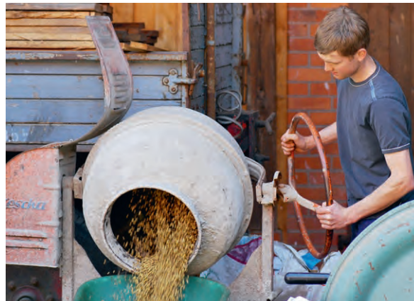
Die Betonmischmaschine eignet sich für die Impfung mittelgroßer Saatgutmengen für maximal 50 ha. Dabei wird das Impfmittel zum Saatgut im Betonmischer dazugegeben und beides mit 3–4 Umdrehungen während zirka 30 s vermischt. Ein längeres Vermischen wird nicht empfohlen.
