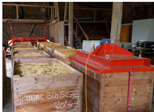
Je nach Produktions- und Lagermengen kommen stationäre Trocknungsanlagen (oben) oder mobile Trocknungsgeräte zum Einsatz.
