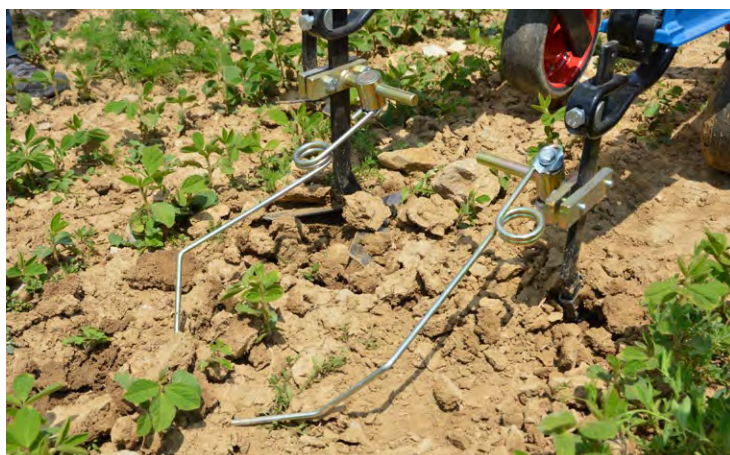
Die Torsionshacke ermöglicht die Regulierung der Unkräuter in der Reihe im jungen Sojabestand. Für die Unkrautregulierung zwischen den Reihen werden Scharhacken verwendet.
