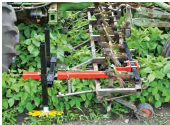
Die Rollhacke/Rotary hoe (oben) bewährt sich besonders bei verkrusteter Bodenoberfläche. In älteren Sojabeständen kommt in der Regel die Kombination von Gänsefußscharen und der Fingerhacke zum Einsatz (unten).
