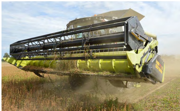
Ein tiefer Schnitt erfasst auch die Bohnen der unteren Stockwerke. Ein zu hoher Schnitt, eine unsorgfältige Ernte oder ein unebener Boden kann zu Ernteverlusten von mehreren Dezitonnen pro Hektare führen.
