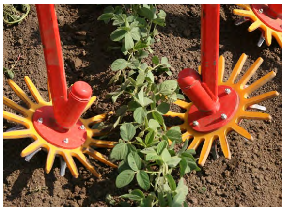
Die Fingerhacke hat sich für die Regulierung der Unkräuter in den Saatreihen bewährt.
