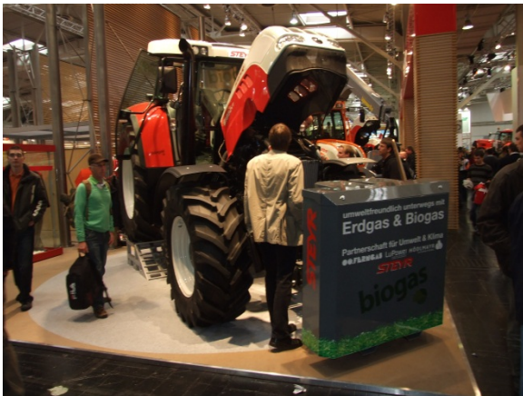
Фигура 30: Първите трактори на биогаз привличат внимание на търговски панаири и на полето, Рафинираният биогаз се съхранява в резервоари под пода или отпред. снимка: Ф. Герлах, МЕР.
