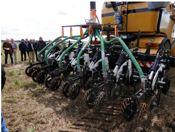
Фигура 16: Технологията на инжектиране на течна оборска тор намалява амониевите емисии, подобрявайки рециклирането на хранителните вещества и намалявайки замърсяването на въздуха. снимка: Н. Холцер, МЕР.
