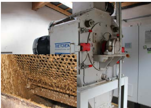
Фигура 22: За средни и големи биогаз инсталации, техниките за разграждане, като тази комбинация от раздробител и специфични микроорганизми, може да подобри ефективността и надеждността. Снимка: F. Gerlach, FiBL.
