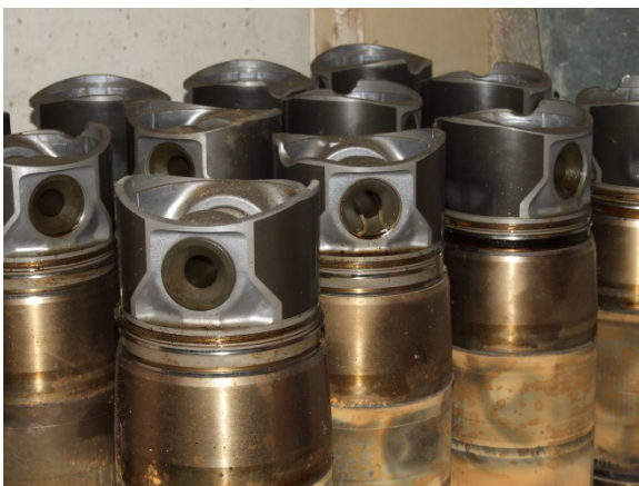
Фигура 28: Жизненоважно за надеждно функциониране е редовния ремонт на когенератора. На снимката: Бутала на цилиндричен двигател. Снимка: F. Gerlach, MEP.
