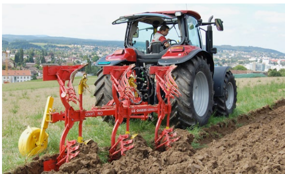
Le labour hors-raie aide à éviter le tassement au niveau de la semelle de labour.
