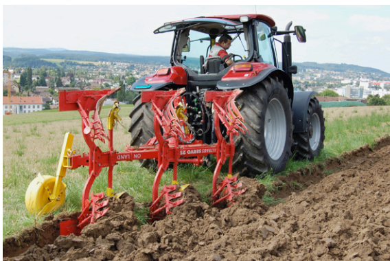
Der Onland-Pflug verhindert die Bodenverdichtung in der Pflugschle.
