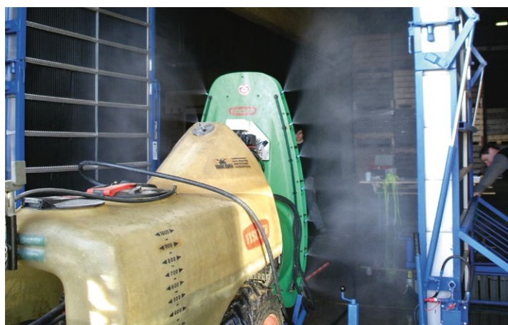
Les pulvérisateurs doivent être testés tous les quatre ans. Cela garantit un réglage optimal des appareils et représente une condition essentielle à la réussite de l'application des produits phytosanitaires.
