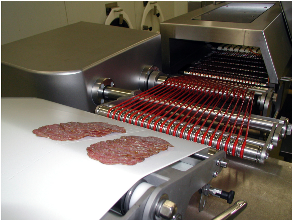
Abbildung 13: Slicer zur Herstellung von SB-Verpackten Wurstwaren Höchste Hygiene ist die Voraussetzung für die Herstellung von aufgeschnittener Ware mit langen MHD. Bild: Chiemgauer Naturfleisch GmbH
