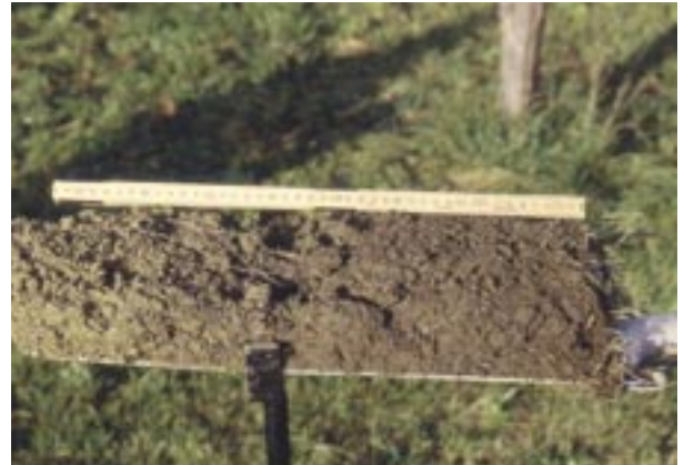
Spatenprobe: Kleiner Aufwand, grosser Nutzen. Diese Methode ermöglicht es auch dem Laien, die Bodenstruktur zu beurteilen.
