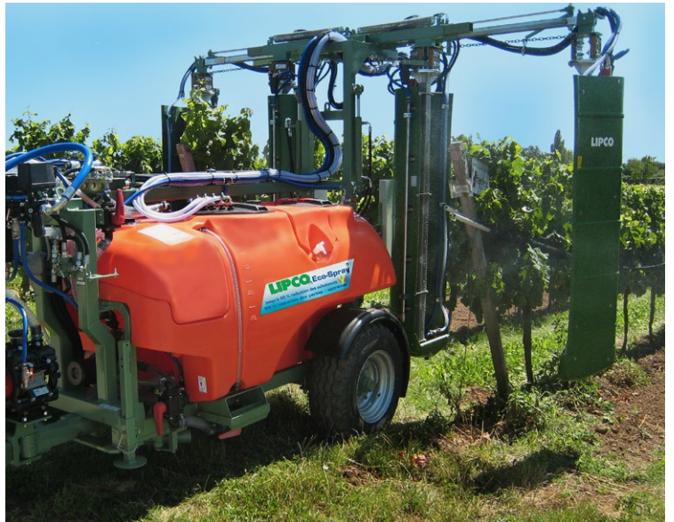
Tunnelsprühgeräte haben seitlich und oben Reflektorwände, so dass sich die Kultur in einem «Tunnel» befindet
