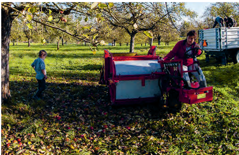
Mit einer selbstfahrenden Auflesemaschine kann die Ernteleistung um ein Vielfaches erhöht werden.
