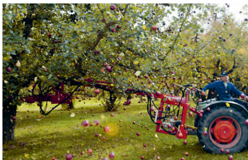
Der Schnittholzrechen und der Baumschüttler tragen zur Reduktion der Anzahl Handarbeitsstunden bei. Der Baumschüttler erhöht zudem die Arbeitssicherheit.
