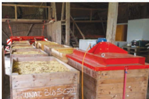
Fig. 33. În funcție de cantitățile de producție și depozitare, se utilizează instalații fixe de uscare (sus) sau unități mobile de uscare (jos).
