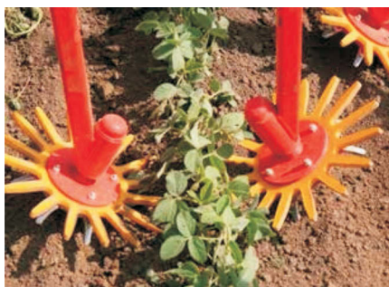
Fig. 22 Plivitorul cu degete s-a dovedit a fi eficient pentru înlăturarea buruienilor din rând
