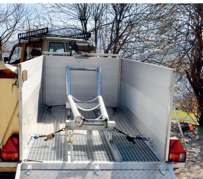
La T-Trailer, autorisée pour le transport du bovin mort, avec le châssis mobile sur lequel l'animal saigné est placé. De telles remorques permettent de transporter la carcasse dans des conditions hygiéniques à un abattoir proche.
