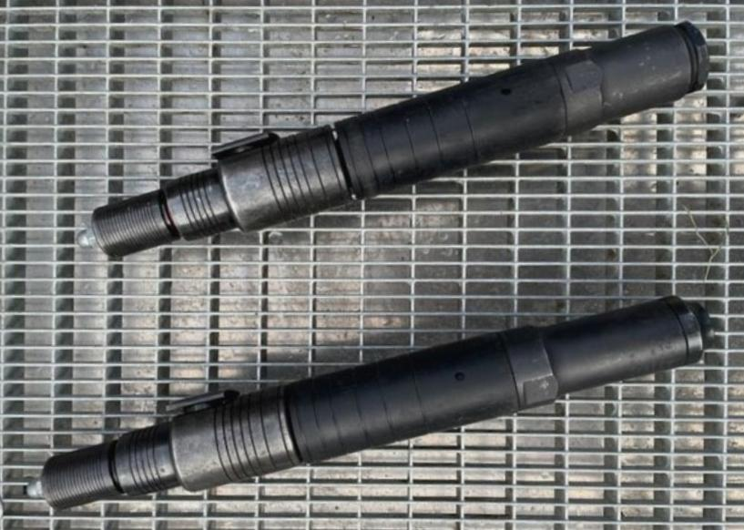
Le pistolet à tige perforante Schermer KL est l'un des pistolets dont la longueur de dépassement de la tige hors de la gaine est de 12 cm. Il n'a pas de système de rappel, mais une plus grande énergie d'impact (en joules).
