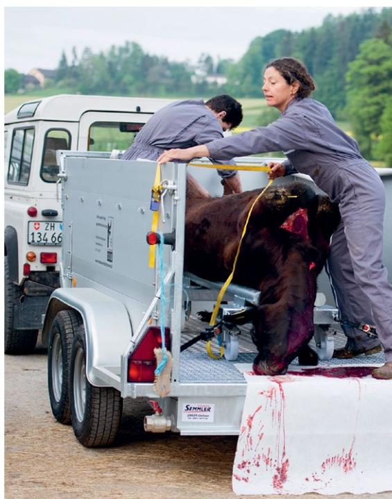
Conçue pour les mises à mort au pré en Allemagne, la T-Trailer est fabriquée en grande partie en aluminium et répond aux exigences fixées par le règlement de l'UE sur l'hygiène. Elle peut être attelée aussi bien à une voiture qu'à un tracteur. Cette remorque convient également au transport d'animaux mis à mort à la ferme.
