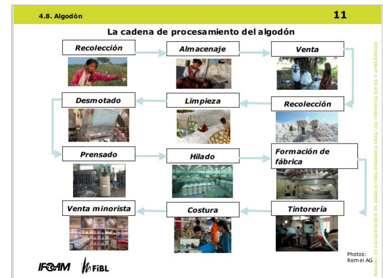
TRANSPARENCIA 4.8 (11): PASOS DE LA CADENA DE PROCESAMIENTO DE ALGODÓN
