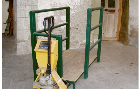
Zur Bestimmung des genauen Gewichts der Kälber wurde ein Wägestand für den Palettrulli gebaut, auf den die Kälber geführt werden.
